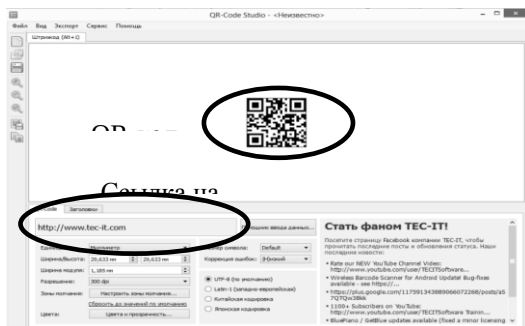
Рис. 3. Интерфейс программы QR-Code Studio и получившийся QR-код
